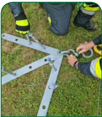
Einsatz von Seilzug und Freianker
