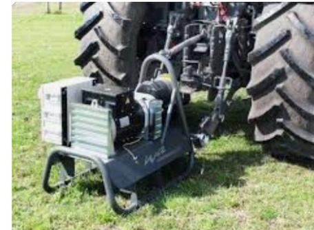
Die 42 Hebe/Pumpwerke werden durch eine mobile Stromversorgung (Zapfwellengeneratoren) vom Klärwerk aufsteigend mit Strom versorgt.
